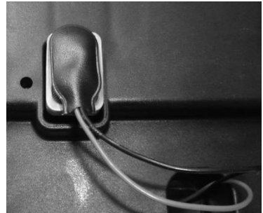
9-V-Blockbatterie für die Notabsenkung
